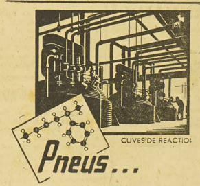
Dans d'immenses usines, les chimistes mêlent et polymérisent le butadiène et le styrène pour produire ce chefd'œuvre de la science moderne, le caoutchouc synthêtique "GR-S."
