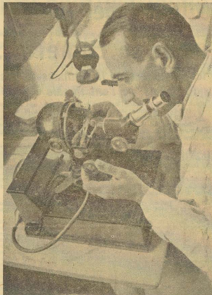
M. P. de Fonbrune règle sa micro-forge pour la fabrication d'instruments microscopiques. L'effilure de verre, au-dessus de sa main droite, est déjà en place. Le fil de platine iridisé, à la pointe de l'effilure de verre, est déjà rougi. De la main gauche, le savant règle la soufflerie afin de donner au fil rouge la chaleur désirée.
