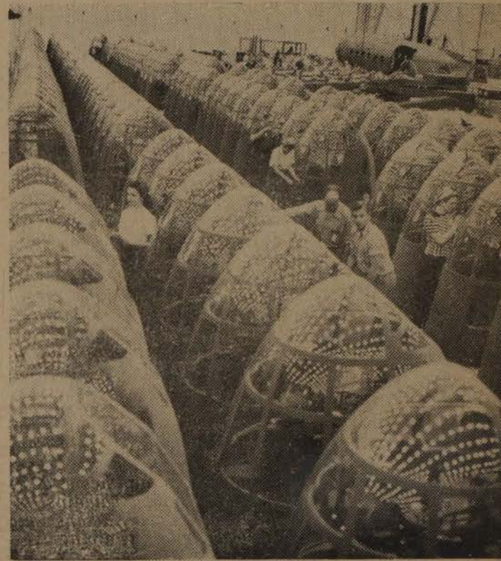
Dans une des plus grandes usines des Etats-Unis les ouvriers Américains examinent les structures d'un Douglas A-20 qui ont rendu d'énormes services tant à l'aviation américaine qu'à la R.A.F.
